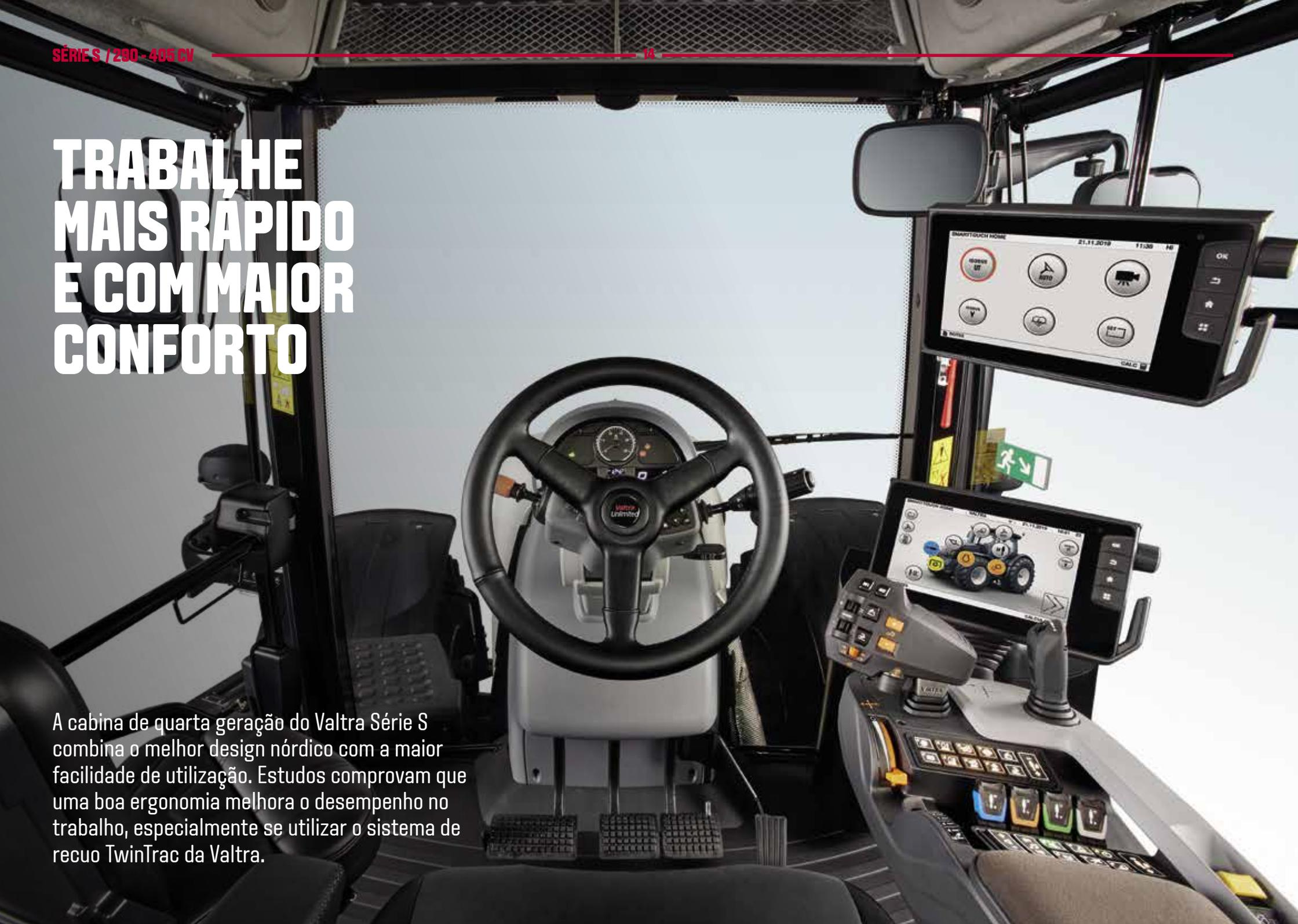
A cabina incorpora a suspensão pneumática assente em quatro pontos, o sistema AutoComfort da Valtra que utiliza a mais recente tecnologia. Os sensores transmitem a informação ao sistema de controlo, que se certifica de que a cabina está sempre na posição correta. O sistema AutoComfort também lhe permite ajustar a suspensão de acordo com a sua preferência.
