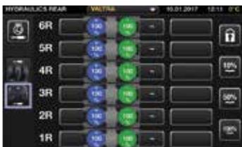
Pode atribuir qualquer controlo para operar qualquer função hidráulica, incluindo as válvulas hidráulicas dianteira e traseira, as ligações dianteira e traseira e o carregador frontal.
