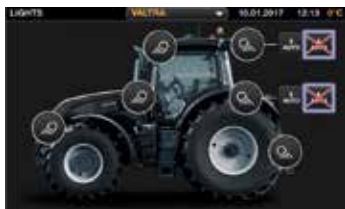
Configuração simples das luzes de trabalho a partir do terminal. Interruptor para ligar/desligar as luzes de trabalho no apoio do braço com interruptor para ligar/desligar o farol rotativo.
