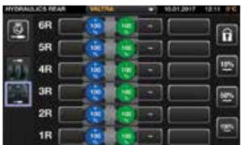
A partir de qualquer controle pode controlar qualquer serviço hidráulico incluindo as válvulas hidráulicas (dianteiras e traseiras), ligações (dianteiras e traseiras) ou carregador frontal.
