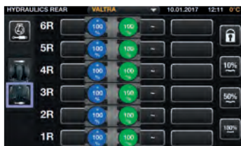
A partir de qualquer controlo, pode controlar qualquer serviço hidráulico, incluindo as válvulas hidráulicas (dianteiras e traseiras), as ligações (dianteiras e traseiras) ou o carregador frontal.
